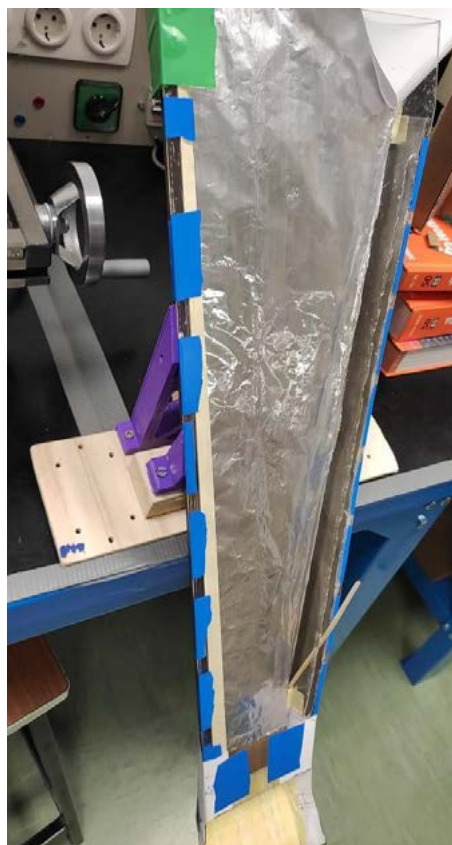
Figura 18. Rampa con doble fondo y vástago
